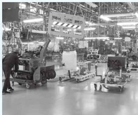
写真4 台車と組み立て治具を一体化。大型機械は分割組み立て後に合体するので、すべて台車上で作業。
