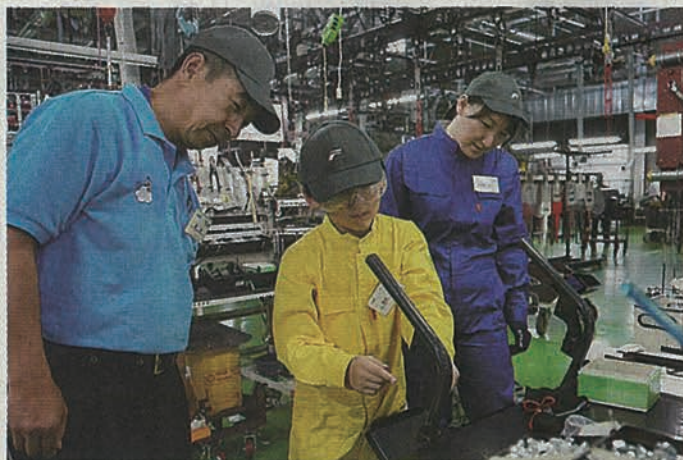
ハンドルに部品を組み付ける作業
