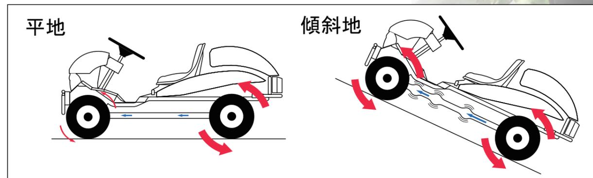
後輪への負荷に応じて前輪が駆動。不整地や傾斜地でも安定した走行が可能。
