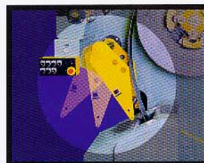
先端挿入アームはコイル材に合わせて前後に動き、コイル材挿入の補助をします。
