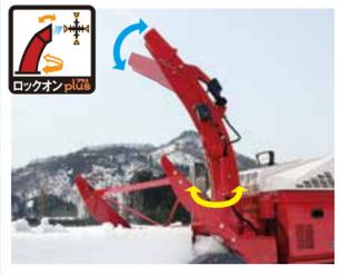
従来の投雪方向に加え、投雪距離の自動制御をプラス。一定の範囲に雪をまとめて飛ばしたい時に便利です。
