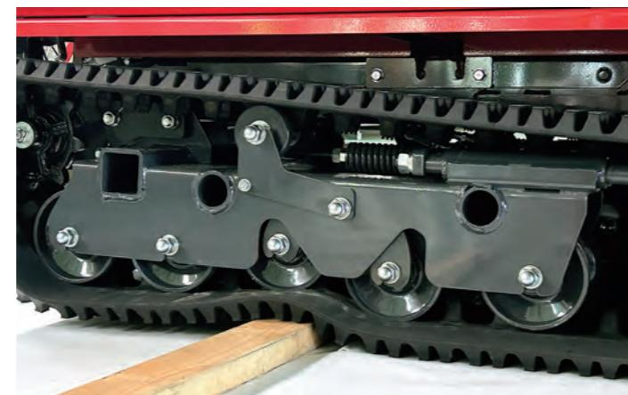
2つの転輪が支点を中心にシーソーのように動くので、起伏のある地面や障害物の乗り越えもスムーズ。特にトラックへの積み下ろしは重心移動時のバウンドが少なく安全。
