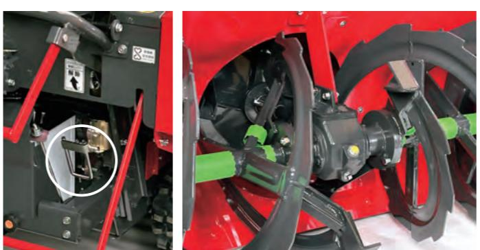
操作部下のレバーを持ち上げるとブロワブレーキが解除され、オーガ・ブロワの空転が容易に。これによりシャーボルトの交換やオーガ・ブロワの雪落としが簡単に。(SQ・SDシリーズ装備)
